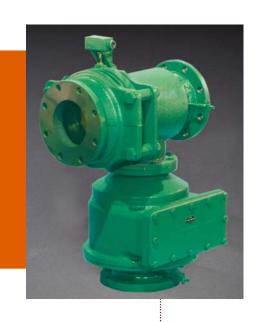
シーラス・ブローアウト逆火防止装置 コンバッションコントローラーまたは混合装置を自動的に保護します。 シーラス・ブローアウトはチェックバルブを備え、ガス流を意図的に大気放出する装置です。通常の稼動状態では、燃料/空気の混合気体はブローアウトを通過します。 逆火が発生した場合、背圧によりチェックバルブが閉じられ、混合ガスの流れを遮断します。次に、圧力上昇によりラプチャーディスクが破壊され、逆火による圧力および高温ガスの配管孔を通して安全な場所へ放出します。ディスクが破壊されると自動的に電気系統のスイッチが閉じられ、燃料の供給を遮断し警報装置が作動します。
