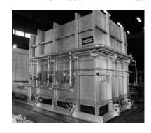
でロールを急速、正確に熱処 理するよう設計されています。 ハイスピード、パルス燃焼式 バーナーにより、温度を均一に 保ち、燃料効率を向上させま す。オプションで炉内蔵型の強 制空冷装置も用意されていま す。
